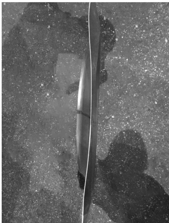
Рис. 1. Явление деформации краев детали (вид сбоку)
