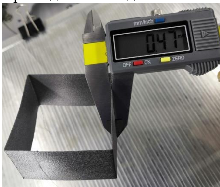
Рис. 1. Толщина стенки до калибровки потока
