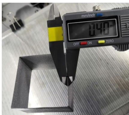
Рис. 2. Толщина стенки после калибровки потока
