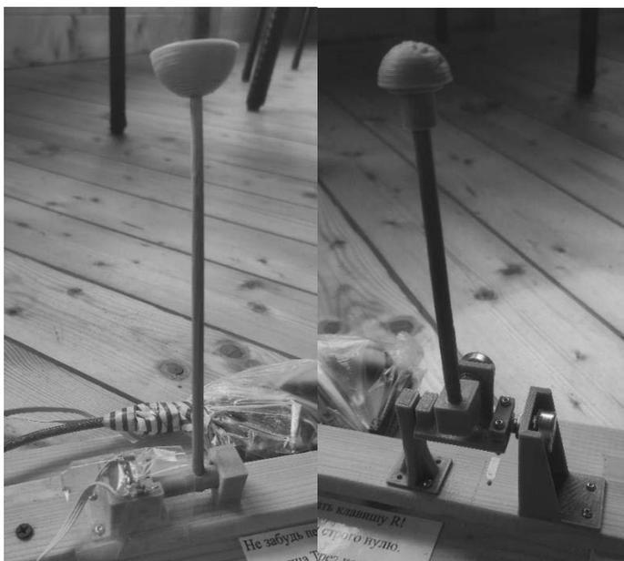
Рис. 2. Рычаг газа(слева) и крена/тангажа(справа) панели управления вблизи
