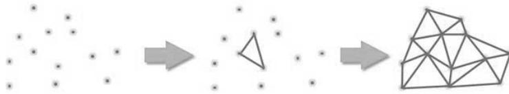
Рис. 3. Схематичное изображение процесса триангуляции.
