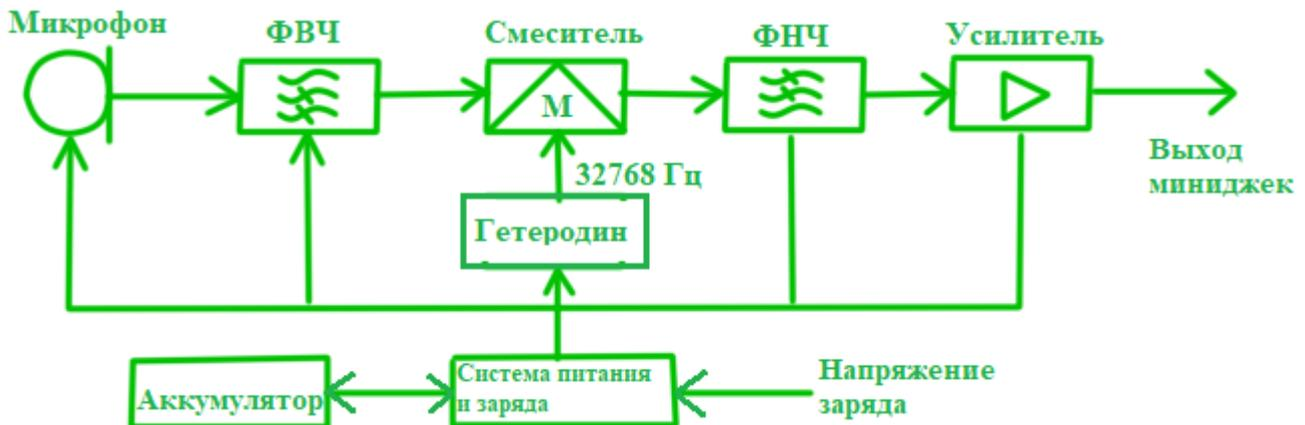
Рис. 2. Структурная схема приёмника сигнала
