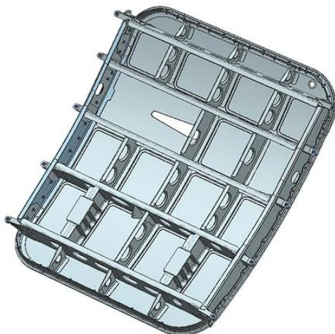
Рис. 1 – Общий вид каркаса багажной двери отсека Ф4 самолета МС-21
