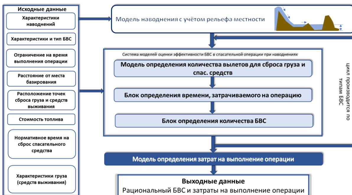
Рис. 1 - Структурная схема модельно-методического аппарата оценки эффективности беспилотных воздушных судов, осуществляющих спасательные операции при наводнениях
